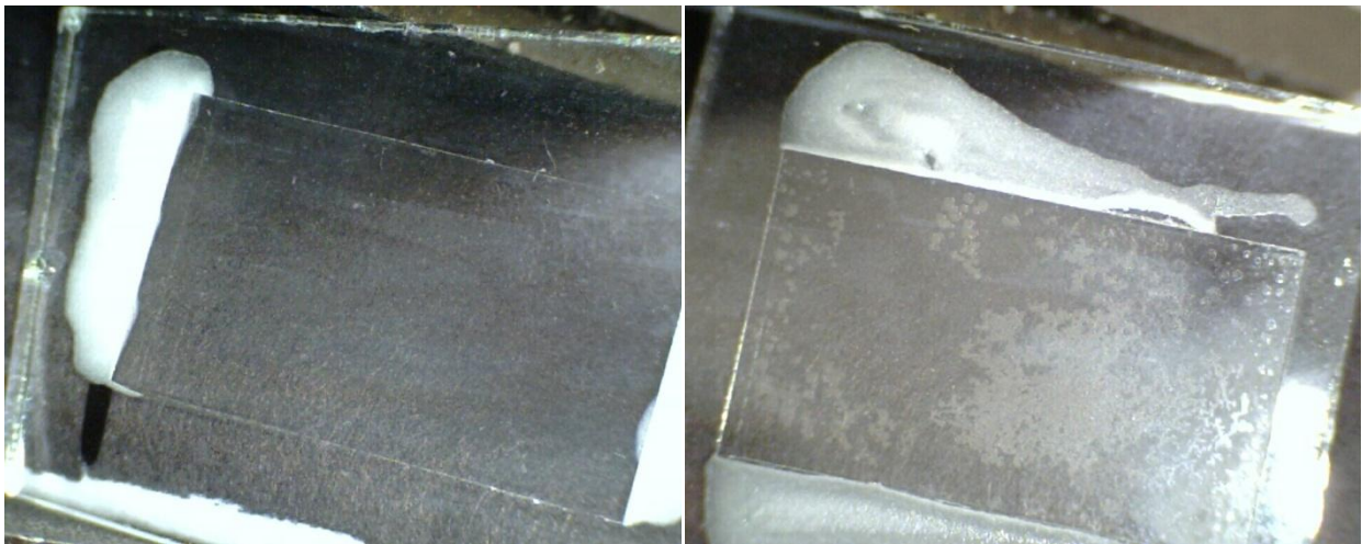
Abbildung 4.16: Dick- und dünnflüssiger Kleber im Vergleich. Rechts ist der dünnflüssige Kleber zu erkennen, der unter die Glasplatte zieht
