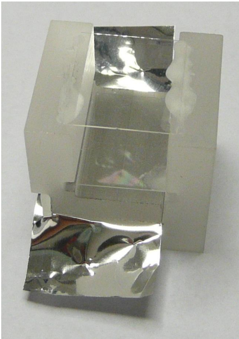
Abbildung 4.19: Fertig geklebtes Dilatometer mit Mylarfolie. Durch die Folie wird sichergestellt, dass auch ohne den Einbau einer Probe eine Kapazität vorliegt. Sie muss noch entfernt werden.
