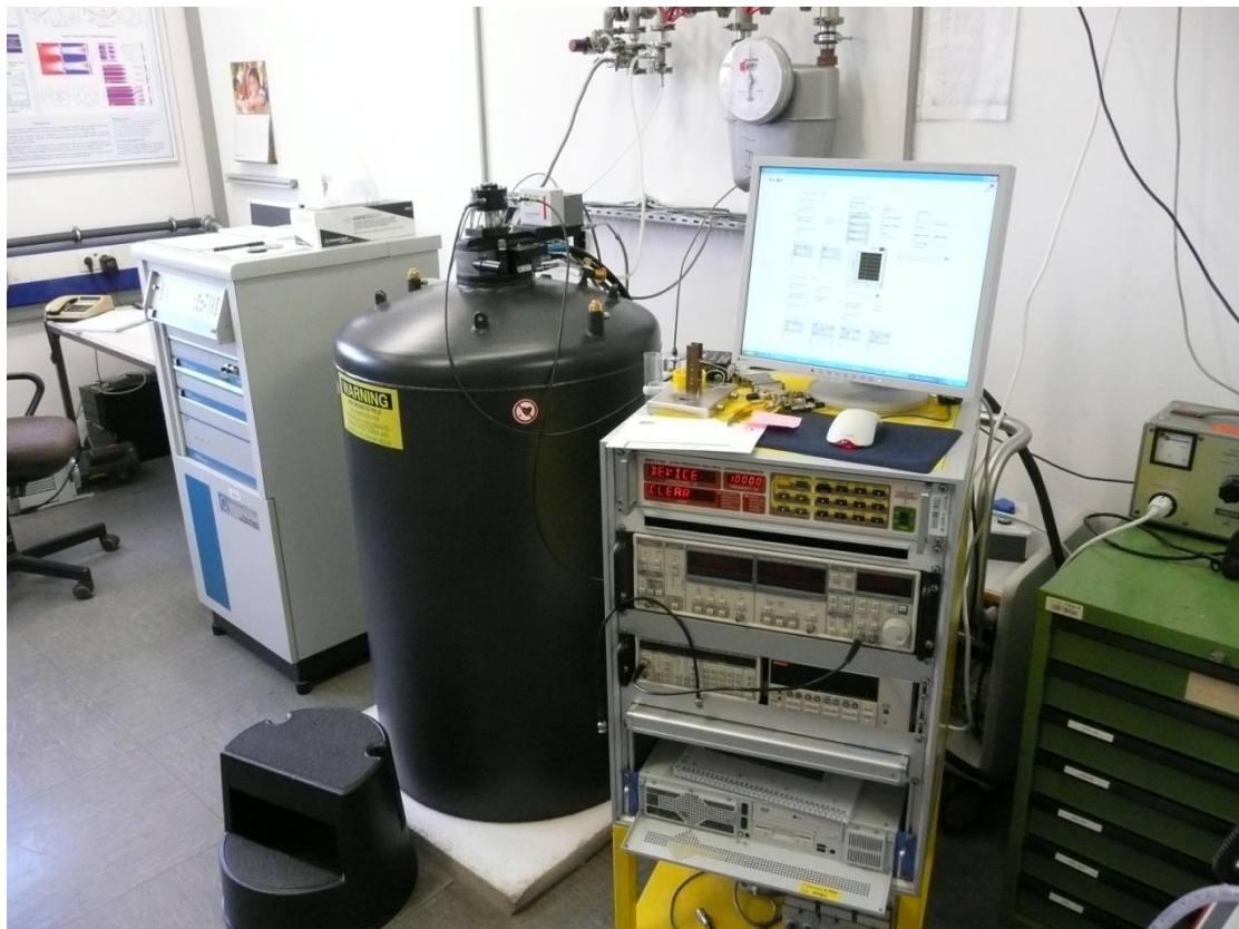
Abbildung 5.1: Auf diesem Bild ist der Kryostat zu sehen, an den der Messcomputer angeschlossen ist.
