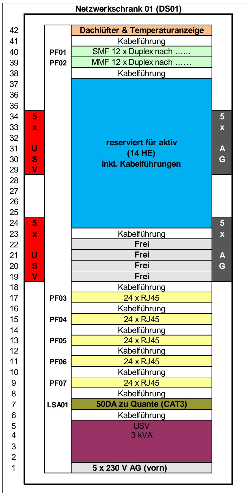
Abbildung 2: Muster-Verteilerschrankaufbau (bis ca.100 Anschlüsse)
