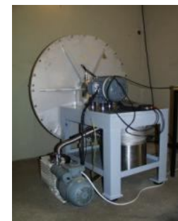
Schleuderprüfstand für die Chopperentwicklung
