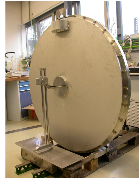
Choppergehäuse aus Edelstahl 1.4571 Innendruck < 1 \times 10^{-3} mbar
