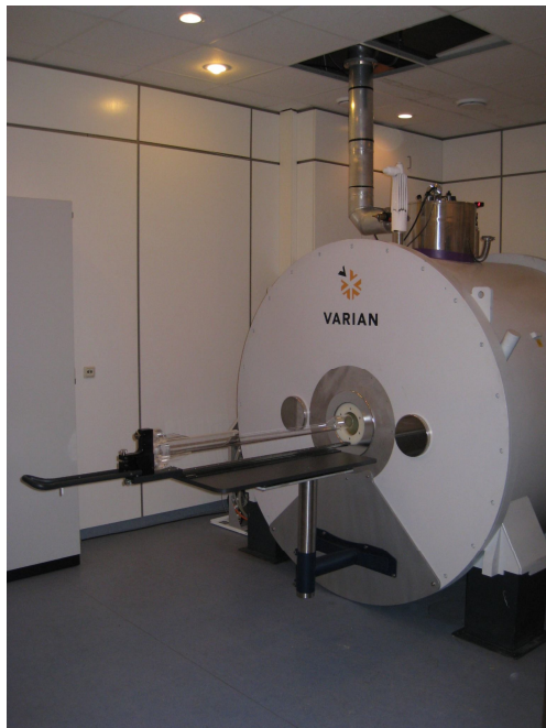
9,4 T MRT-Kleintierscanner mit installiertem Tierbett
