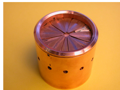
Verschlussblende (Shutter) mit 12 konzentrisch öffnenden Kupfer-Feder-Elementen
