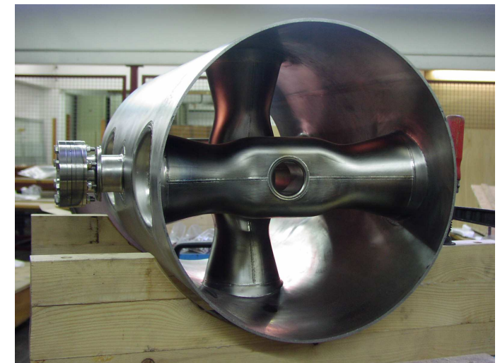
Resonatorhülle nach Einschweißen der Speichen. Die Endkappen werden später auf den Resonator geschweißt.
