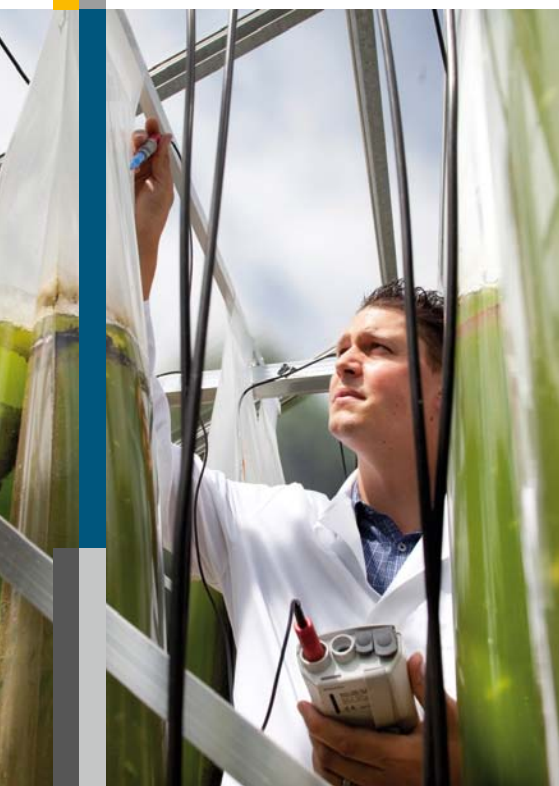
Der Wissenschaftler Thorsten Brehm untersucht die Salzwasser-Algen-Mischung in den Kunststoffschläuchen der Pilotanlage in Niederaußem.
